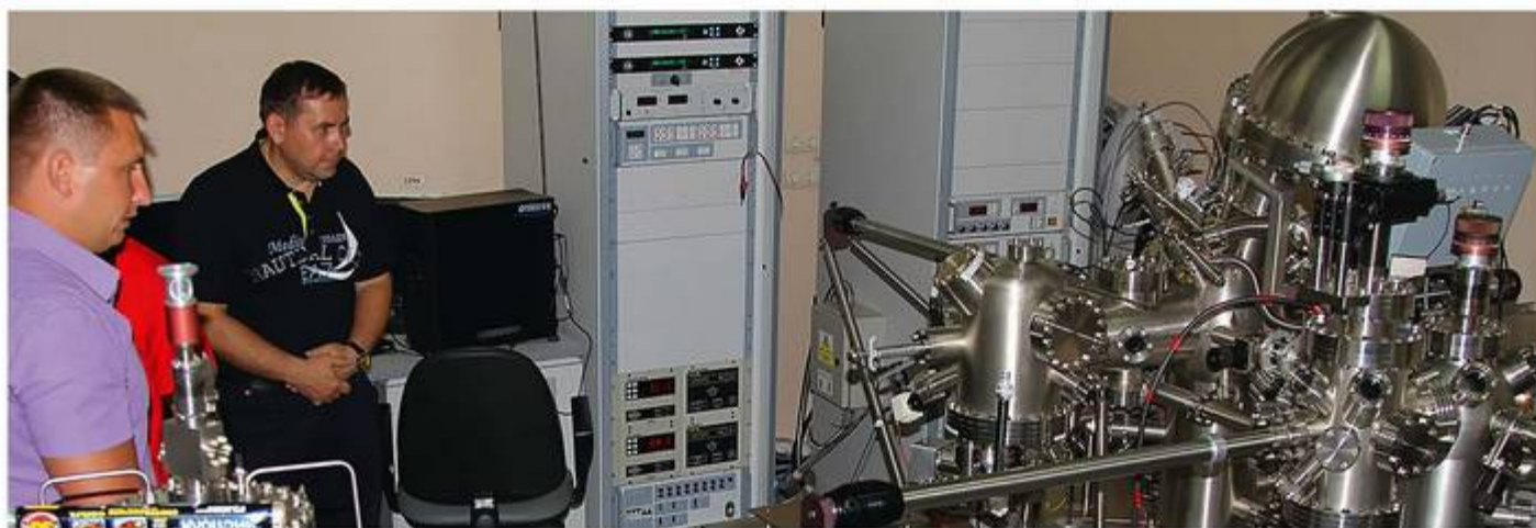
▲ Установка молекулярно-лучевой эпитаксии (выращивания кристаллических наноструктур в условиях глубокого вакуума) «Омикрон» в Дальневосточном федеральном университете
